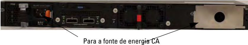
Figura 1-9. Duas fontes de alimentação redundantes no N3132PX-ON
